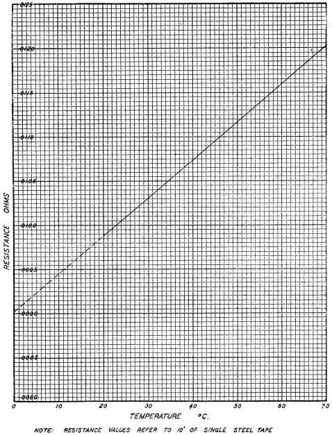
FIG. VI.---RESISTANCE AGAINST TEMPERATURE FOR STEEL ARMOUR
